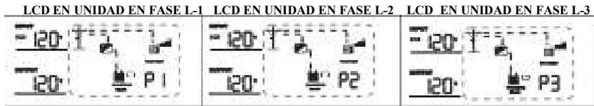
Paso 5: Si no se muestra más la alarma de falla, el sistema para apoyar equipos trifásicos está completamente instalado.
