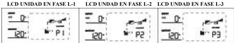
Paso 4: Encienda todos los corta circuitos CA de los cables en Línea en la entrada CA. Si la conexión CA es detectada, las tres fases emparejadas con la configuración unida, trabajaran normalmente. De otra manera, si muestra la advertencia 15/16 no trabajaran en modo en Línea.
