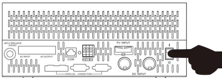
Una vez que el dispositivo esté correctamente instalado, coloque el interruptor de encendido y apagado en posición ON. (Se encuentra en la parte inferior derecha del equipo).
